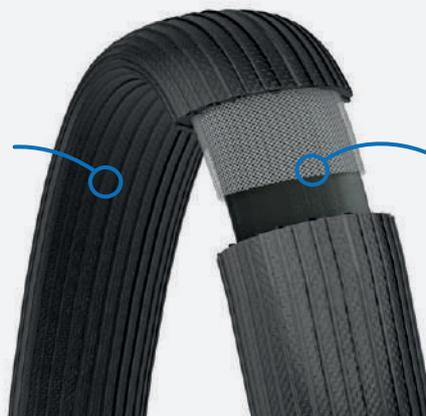
Elastomère NBR noir/PVC, lisse renforcé de fils polyester tissés circulairement pour une parfaite homogénéité Tube/Revêtement.
